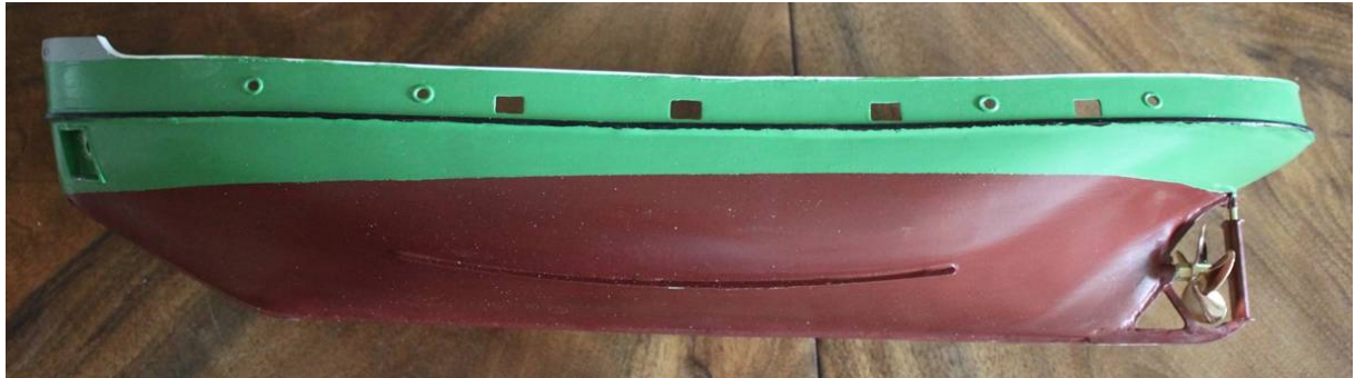
Rumpf Farbgebung – zu beachten ist, dass das Schiff achtern einen deutlich größeren Tiefgang hat (siehe Planunterlagen Seitenansicht)
