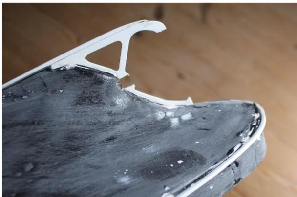
Dann wird für das Achtersteventeil (2mm dickes Polystyrolfrästeil) eingepasst. Die Öffnung für das Stevenrohr wird zweckmäßigerweise erst nach dem Verkleben vorgenommen damit die Teile oberhalb und unterhalb des Stevenrohrdurchbruchs fluchtend in der Mittelachse sind.
