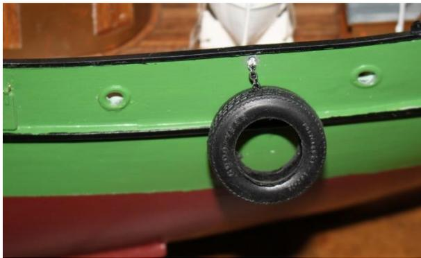
An den Seiten werden die kleinen Reifenfender montiert. Dazu wird ein kleines Loch in das Schanzkleid gebohrt durch die man alternativ eine Kette oder Takelgarn zieht.
