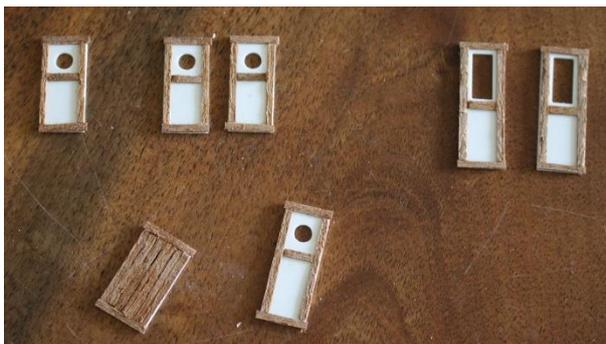
Im Aufbau und bei den Niedergängen werden Türen benötigt. Dafür gibt es Frästeile aus 1mm dickem Polystyrol, die mit dem Teakholzfurnierstreifen belegt werden. Zunächst die Rahmen kleben und dann die inneren Flächen ausfüllen. Bullaugen können zunächst mit den Holzleisten
