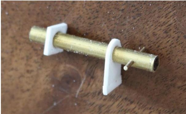
Den gleichen Pollertyp gibt es an der Seite des Schiffs. Auch hier wird in das 4mm Messingrohr die Bohrung für die Querstange gebohrt. Bevor die aber eingesetzt wird empfiehlt es sich die Platte zu montieren mit der der Poller am Handlauf des Schanzkleids befestigt wird.
