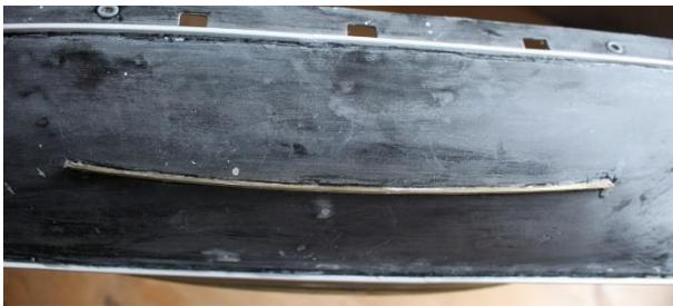
Der Schlingerkiel besteht aus 2x3mm Messing-L-Profil. Der Abstand zur Schiffsmittelachse beträgt 50mm. Die Schlingerkiel verlaufen von unten gesehen parallel zur Mittelachse und nur in der Seitenansicht haben die einen gebogenen Verlauf. Das
