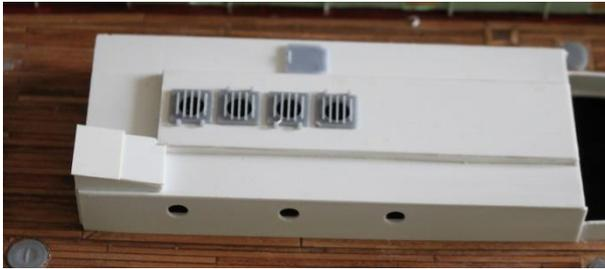
Über den quadratischen Öffnungen werden die Oberlichter des Maschinenraums montiert sowie seitlich davon eine der drei Klappen. Am hinteren Ende wird der Niedergang montiert. Zur Seite bleibt 1mm Abstand; die schmalen Enden
