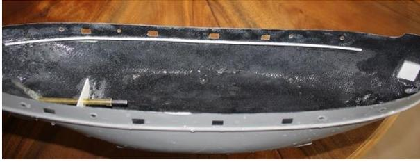
Innen wird nun 2x2 Polystyrolprofil als Auflage für das Deck eingeklebt. Das Deck selbst besteht aus 1,5mm dickem Polystyrol – daher muss die Leiste so verklebt werden, dass sie 2mm unterhalb der Unterkante der
