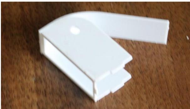
Der achtere, höhere Niedergang wird zusammengesetzt. Das Dach verklebt man am besten mit etwa 1mm Überstand zunächst oberhalb der Tür und nach Aushärtung dann den Rest. Das Dachteil ist etwas länger als benötigt und wird zum Schluss an der Unterkante beschnitten. Achtung! Vor dem
