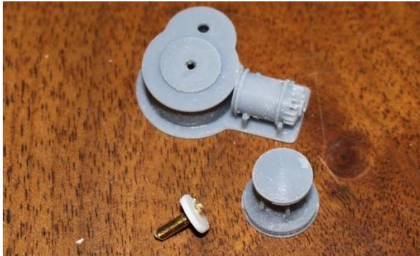
Die Achterwinde besteht aus einer fast quadratischen 1mm Polystyrolplatte als Sockel. Darauf wird das große Resindruckteil montiert nachdem mit einem kurzen 2mm Messing Draht der Spillkopf auf dem Windensockel montiert wurde (die kleine weiße Platte dient als Sicherung). Die Motoratrappe wird auf die seitlichen Stützen geklebt.
