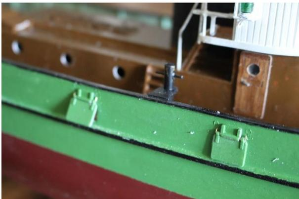
Außen am Schanzkleid werden die Speigattklappen befestigt. Diese bestehen aus der Klappe selbst und einem Scharnierteil. Die Bohrungen reichen für einen 0,5mm Draht. Wenn man die Speigattklappen vorsichtig mit Sekundenkleber befestigt und verhindert, dass Kleber ins Scharnier läuft bleiben die auch beweglich.
