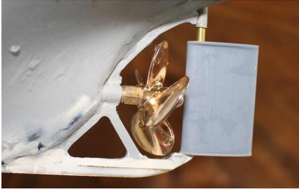
Beim Einbau des Ruderkokers ist darauf zu achten, dass die Ruderachse kurz vor Ende der Ruderhacke aufliegt (ggf. bis zum Abbinden des Klebers die Ruderachse an der Ruderhacke mit Klebeband fixieren). Nach oben steht die Ruderachse etwas über das Deck über. Bei Versagen der Rudermaschine konnte
