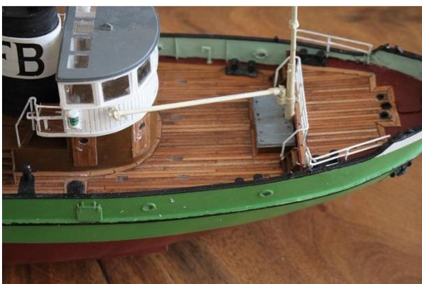
Der obere Teil des Masts besteht aus 3mm Vollprofil (Länge 137mm), 1mm Bohrung 7mm oberhalb Unterkante, unteres Ende an den Seiten abflachen auf eine Dicke von etwa 2mm (so das bei Verbindung mit einem 0,8mm Draht der obere Teil kippbar bleibt und der Schlitz abgedeckt ist).
