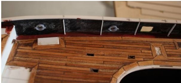
Rumpf Farbgebung – zu beachten ist, dass das Schiff achtern einen deutlich größeren Tiefgang hat (siehe Planunterlagen Seitenansicht)
