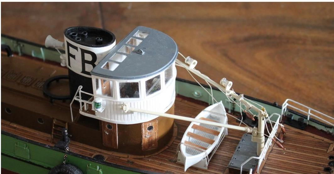
Das Dach des Steuerhauses habe ich mittels Magneten fixiert. Wenn der Mast aufgeriggt ist, wird er ja achtern an der Decksöse auf dem Steuerhausdach angeschlagen. Wenn man an das Innenleben des Modells möchte, wäre es unpraktisch, wenn der Aufbau komplett am Mast hängen würde. Alternativ kann man aber natürlich auch die Befestigung an der Decksöse auf dem Dach lösen.
