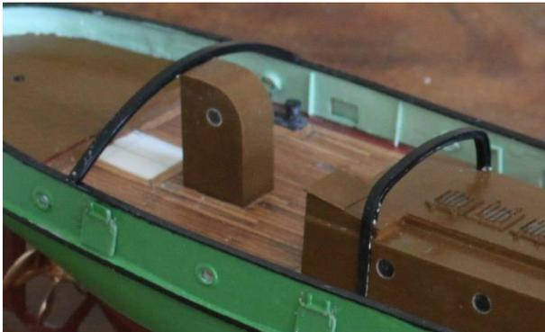
Ebenso wird der achtere Trossenabweiser aufgebaut. Seine Position ist unmittelbar hinter der Dachkante des größeren Niedergangs. Nachdem auch hier die Verstärkungstreifen angeklebt sind, werden die vier kleinen Dreiecke (Frästeile 1mm) in der Fuge zwischen oberem und unterem Verstärkungstreifen und dem
