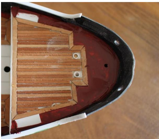
Nun wird das Vordeck aufgeklebt. Die 4mm Polystyrolrohre für die Ankerklüsen setzt man mit Überlänge ein und längt sie erst nach dem Verkleben genau ab. Auf Dichtigkeit achten!
