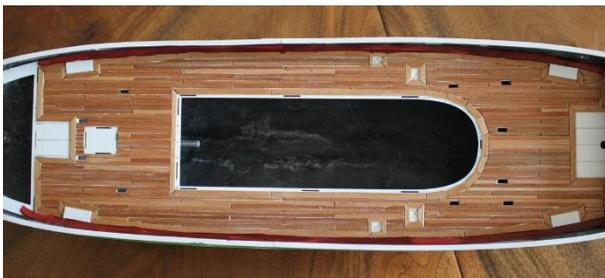
Die Decksleisten nicht bündig aneinanderkleben, sondern einen feinen Spalt (um 0,1mm) zwischen ihnen lassen. Nach Verlegung aller Leisten kann man diese erst mit Klarlack streichen und dann großflächig wasserlöslichen Holzkitt auftragen und mit einem Rakeel in die Fugen drücken. Abtrocknen lassen, mit einer Klinge abziehen und schleifen (abgetragenen Holzkitt
