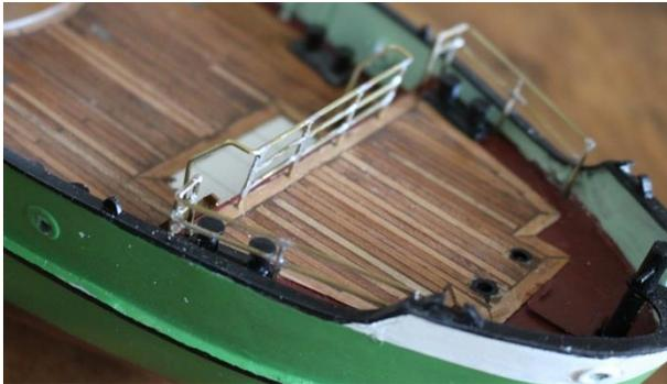
Eine Skizze auf einem Restholz dient zweckmäßigerweise zur Ausrichtung der Teile, die man für das Verlöten dann mit Tesakrepp fixieren kann. Es wird 1mm Messingstab genutzt. Die 4 Stützen haben eine Höhe über Deck von 15mm, 2 Durchzüge mit 5mm Abstand.
