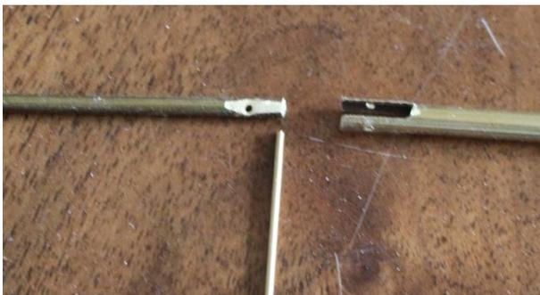
Der Mast war im Original umklappbar um die Knippelsbro in Kopenhagen unterqueren zu können. Um dieses Kippgelenk nach zu bilden, wird quer durch das 4mm Rohr (Länge 64mm) am oberen Ende ein 1mm Loch gebohrt (für die Achse aus 0,8mm Messing). Dann wird ein entsprechender Schlitz mit einer Trennscheibe geschnitten (ca. 9mm tief).
