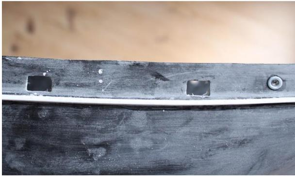
Auf die angedeutete Position wird die Scheuerleiste aus 2x2mm Polystyrol aufgeklebt. Insbesondere im Heckbereich sollte man das Profil vor dem Verkleben etwas rund biegen.
