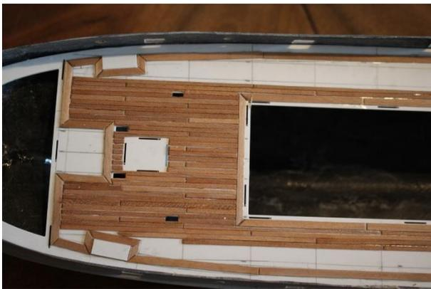
Die Verklebung kann auch gut mit Polystyrolkleber erfolgen. Den Kleber auf die abzudeckende Fläche auftragen, kurz warten (damit das Polystyrol leicht angelöst wird) und dann andrücken. Das angelöste Polystyrol geht mit der Porenstruktur der Furnierleisten eine gute Verbindung ein.
