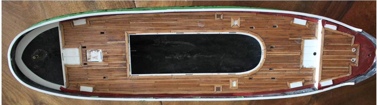
Gesamtansicht der Decks mit Beplankung
