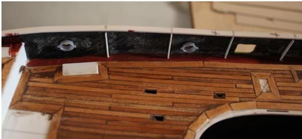
Auf der Innenseite des Schanzkleids werden die Klüsen (Resindruckteile) montiert und die Schanzkleidstützen (0,5mm Polystyrolfrästeile) Der Wassergang wurde oxidrot lackiert.
