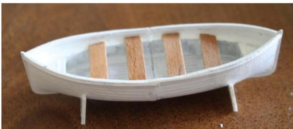
Das Rettungsboot wird zunächst aus den zwei Resindruckteilen zusammen gesetzt. Dafür am besten an der Schnittstelle erst einmal die Grate entfernen. Die Auflagen habe ich für die Montage am Rettungsboot verklebt und die dünnen Sitzbretter
