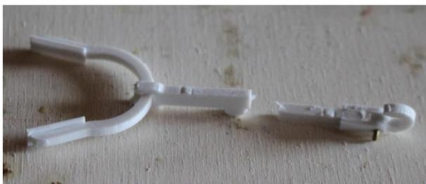
Der Schlepphaken hängt an einem etwas kleineren 2x2mm Polystyrolprofil. Für die Aufnahme des beweglichen Schlepphakens muss der halbrunde Teil an den Kanten etwas abgerundet werden. Unter die
