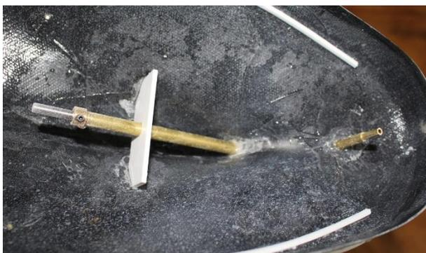
Es folgt der Einbau des Stevenrohrs das innen im Rumpf durch die Stevenrohrstütze geführt wird. Die Form der Stütze muss ggf. der Innenkontur des Rumpfes angepasst werden.
