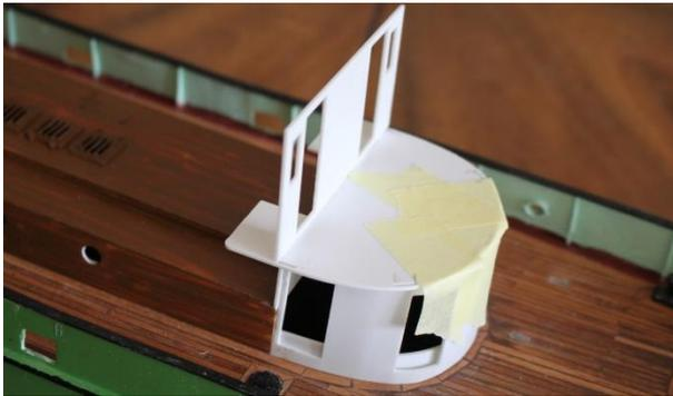
Diese Wand dann mit dem bereits montierten hinteren Teil des Aufbaus verkleben. Um eine optimale Passgenauigkeit über den Süllrand zu erzielen, macht man das am besten auf dem bereits montierten Deck. Unbedingt darauf achten, dass kein Kleber zwischen Aufbau und Süllrand kommt (z.B. in dem man etwas Papier oder Folie dazwischen steckt).
