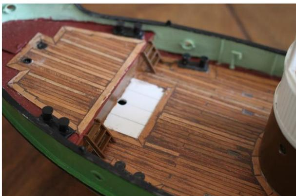
Sofern noch nicht montiert, können nun die Doppelpoller verklebt werden. Zweckmäßigerweise ebenso wie die Tankentlüftungen beim Schanzkleid und die (um eine Stufe gekürzten Treppen) vor der Montage lackieren.
