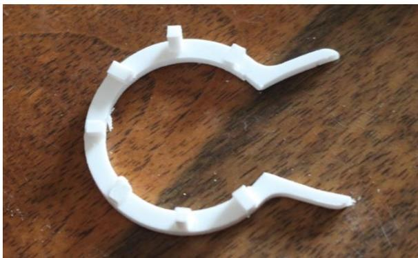
Das Schleppgeschirr besteht aus einem großen Frästeil (2mm dick) auf dem entsprechend des Bildes 2x2mm Polystyrolprofil als Distanz zum flacheren Aufbau angeklebt wird. Dieses Teil dann mit den Distanzstücken nach unten und der Öffnung nach vorne am Aufbau und dem Schornstein festkleben. Der Ring dient als Auflage für den beweglichen Schlepphaken.
