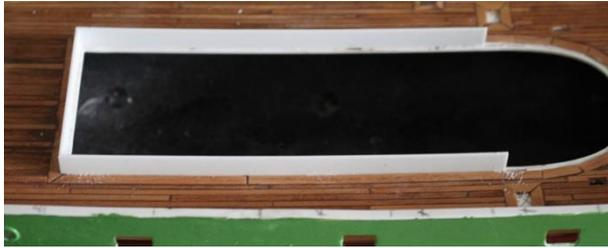
Nun wird beim Deck der Süllrand des Aufbaus eingeklebt. Zweckmäßigerweise beginnt man mit den beiden Seitenteilen zwischen die dann das quer Schiff befindliche Teil geklebt wird. Die für die Aufnahme der an der Unterkante des Süllrands
