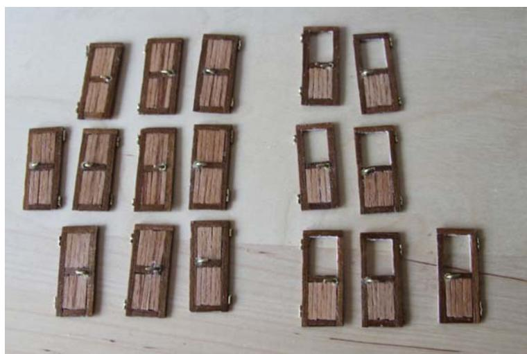
Ebenso kann man bei den Türrahmen verfahren – einfacher ist es aber die Rahmen an der Rückseite der Türen zu montieren und dann gleich die ganze Tür am Modell. Für die Türen gibt es Rohlinge aus 0,5mm Flugzeugsperrholz, die noch mit Furnierstreifen beklebt werden müssen. Der
