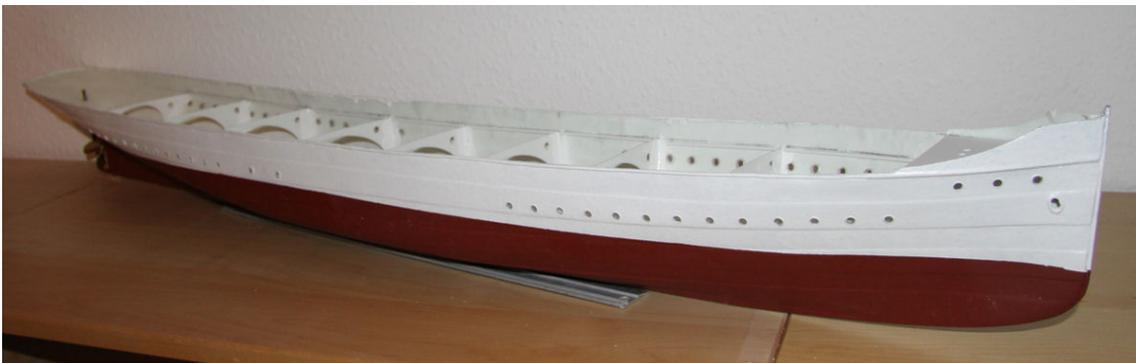
Bevor das Hauptdeck eingeklebt wird, ggf. auch noch den Motor und das Ruder montieren (das Ruder besteht aus der Ruderachse (3mm Messinggrundstab), dem Ruderblatt (2mm Polystyrol) und den dünneren Rahmen (0,4mm Polystyrol)).
