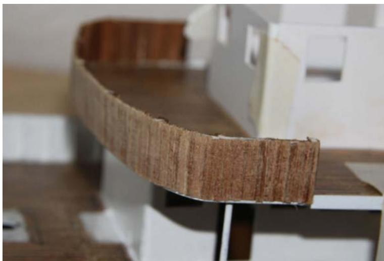
Zur Abstützung des dünnen Materials werden kurze Abschnitte des 2x2mm Profils auf das Deck geklebt – dann wird der Streifen aus dem 0,5mm Material mit Deck und Stützen verklebt.
