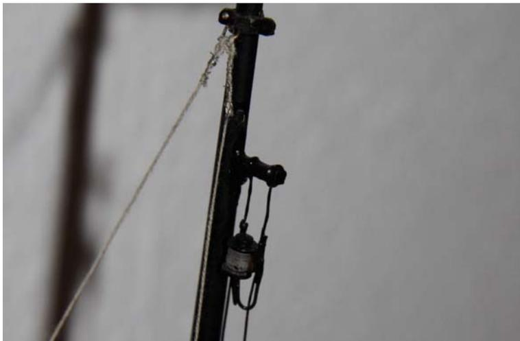
Vorliegendes Bildmaterial zeigt Laternen, die knapp neben dem Mast an zwei Führungsseilen hochgezogen und niedergeholt werden konnten. Dafür lässt sich gut Lackdraht nutzen, der oben und unten um ein Polystyrolprofil gewickelt und verklebt wird.
