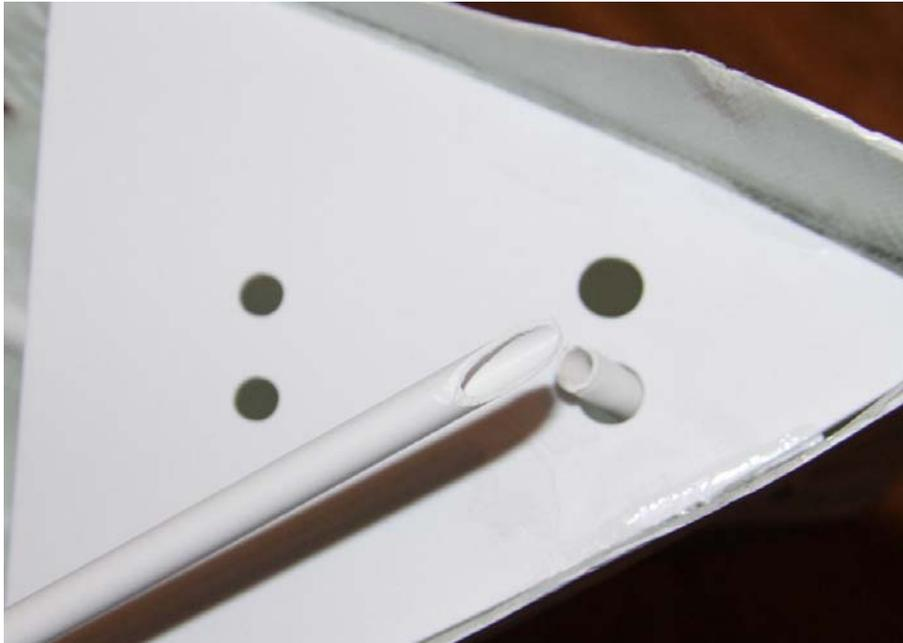
Spätestens jetzt sollten die beiden Teile des Hauptdecks eingeklebt werden. Mit der Verklebung vom Heck aus starten, denn die Bohrung für den Ruderker gibt die richtige Lage des Decks wieder. Am Bug muss das Hauptdeck bis unter die trapezförmige Wand passen, die zwischen Haupt- und Backdeck passt. Den Stoß der beiden Deckshälften zweckmäßigerweise von unten mit einem Polystyrol-Reststück verstärken.
