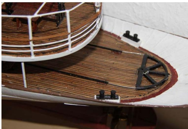
Das nebenstehende Bild zeigt das Achterschiff. Die freitragenden Decks sollte man beim Beplanken abstützen! Dafür eignen sich Reststücke des Polystyrols, die man auf die Höhe der Aufbauwände abgelängt hat.
