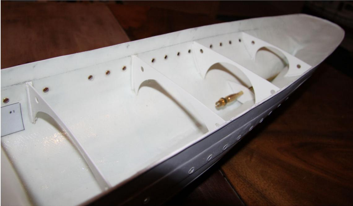
Zwischen den Decksunterzügen werden dann aus 2x2mm Polystyrolprofil Abschnitte auf Höhe der angezeichneten Hilfslinie montiert auf denen später die Seiten des Hauptdecks verklebt werden.
