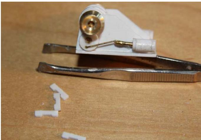
In die Zylinder wird ein kurzer 1mmStab eingeführt und mit einem 0,5mm Stück zur Excenterscheibe verlängert.
