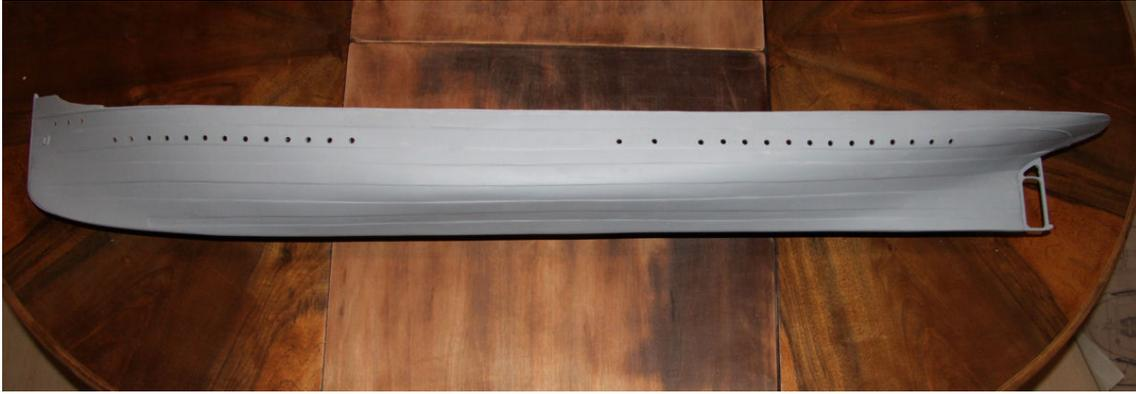
Damit sind die Arbeiten an der Außenseite des Rumpfs fast abgeschlossen. Achtern ist noch ein Stück 2mm Halbrundprofil anzubringen (ca. halbe Entfernung Ruderkoker – äußerstes Ende). Die Position bitte dem Plan entnehmen. Ebenso ist dieses Profil für den oberen Abschluss des Schanzkleids am Bug vorgesehen.
