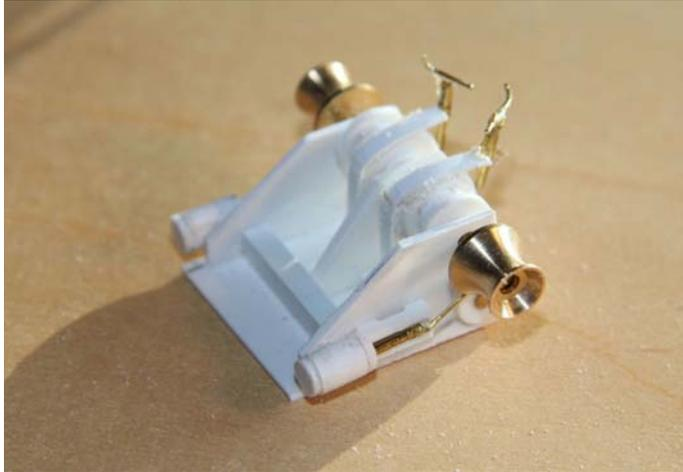
Die Bänder der Bremse werden am Boden verklebt und dann über die Bremsscheiben gezogen. Die Bremsspindel besteht aus 1mm Rundstab – die Handkurbel aus 0,5mm Material
