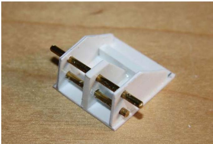
Bodenplatte, Seitenteile, Mittelstütze (die kaschiert die Zahnräder), die Querstrebe und die beiden Wellen sind bereits montiert.
