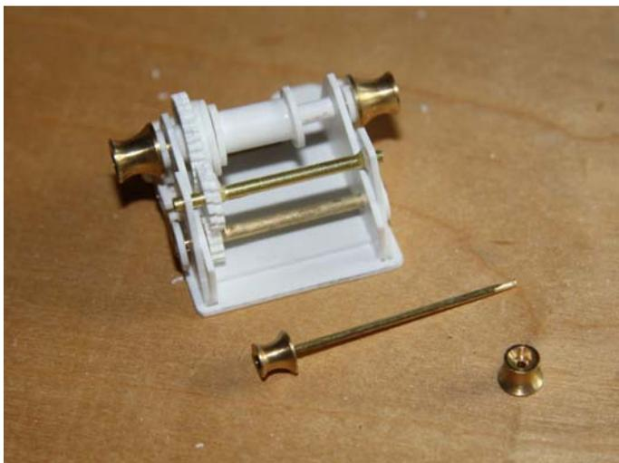
Für die kleineren Spills wird das mittlere Zahnrad verwendet.
