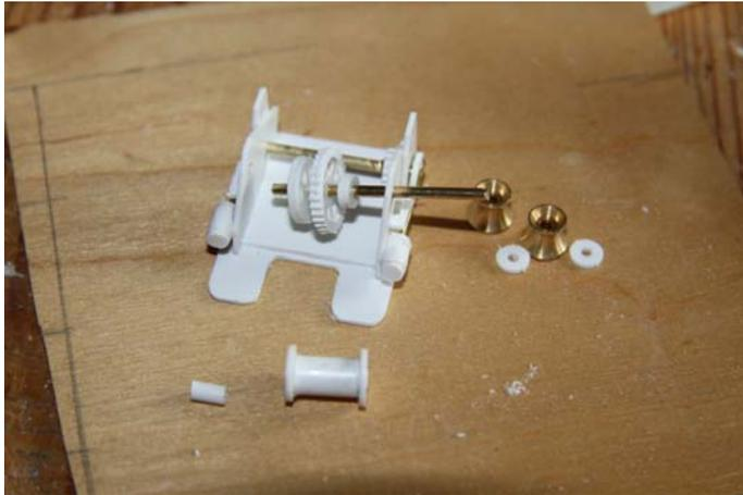
Beim Einführen der Welle wird zunächst eine Distanzscheibe eingesetzt, dann das Zahnrad, die zweite Distanzscheibe, das Bremsrad, die Trommel und der Rohrabschnitt (D3mm - Abstandshalter)
