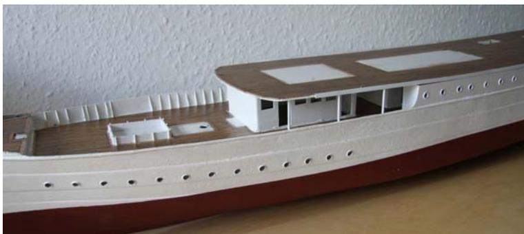
Das Promenadendeck hat erhebliche Decksüberstände: Zur Abstützung werden Decksstützen (2mm Messing) gesetzt. Die Lage ist dem Plan zu entnehmen.
