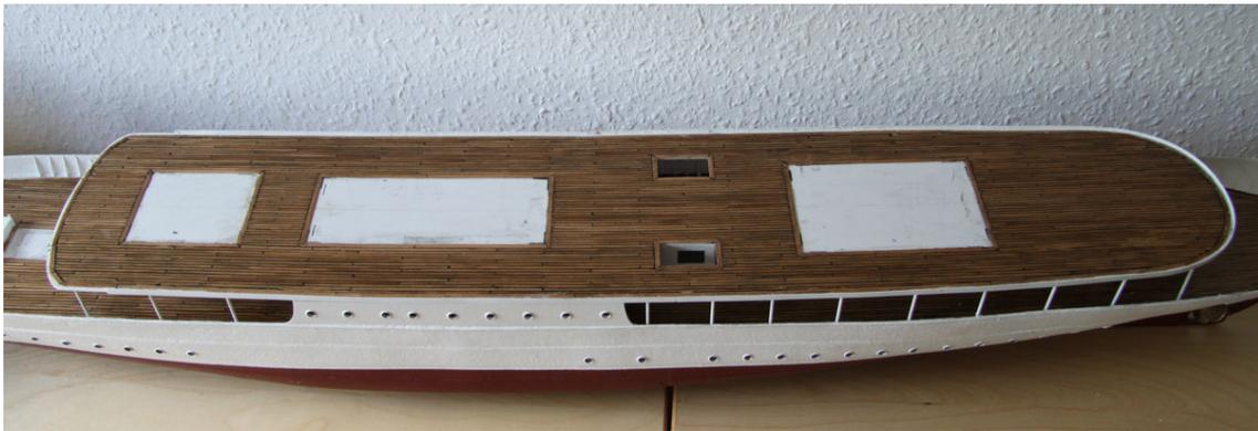
Der Aufbau der Wände des Promenadendecks erfolgt analog zum Hauptdeck (Viertelstabprofile in den Ecken beim vorderen und achteren Aufbau – Ecken beim mittleren Aufbau).
