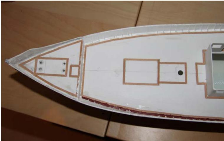
Beginnend an der Mittellinie zweckmäßigerweise abwechselnd nach links und rechts Planken verkleben und an den Hilfslinien ausrichten.
