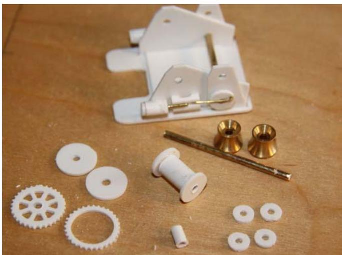
Für die Windentrommel wird der Rohrabschnitt aus Polystyrol mit zwei mittleren Scheiben verklebt.
