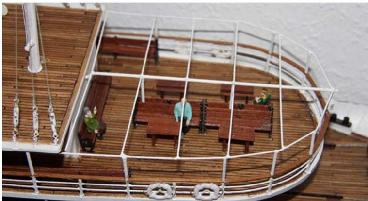
Auf den Fotos ist die Konstruktion ohne Bespannung zu sehen. Für die Bespannung würde ich dünnsten Stoff empfehlen, der im Gegensatz zur Persenning der Beiboote hell sein sollte.
