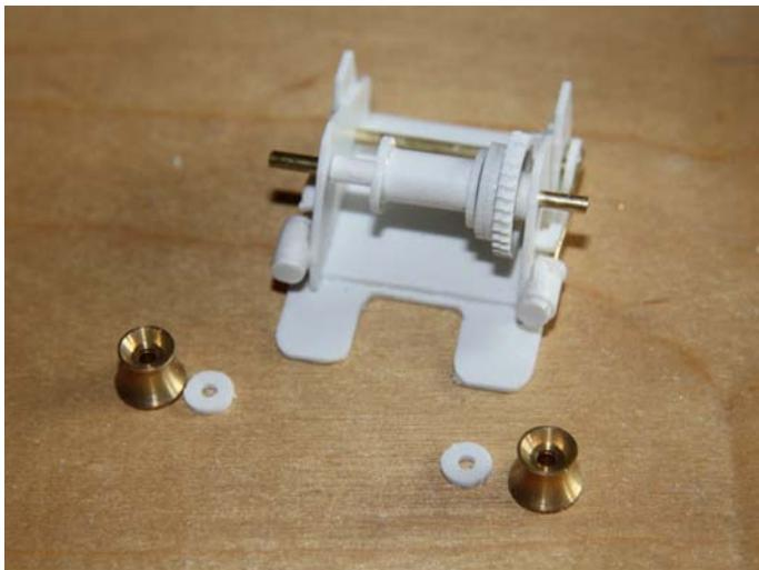
Sind die Teile mittig ausgerichtet, werden außen zunächst die Distanzscheiben und dann die größeren Spillköpfe montiert.
