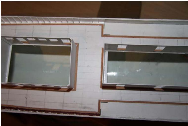
Ausgehend von der ersten verklebten Planke die seitlich anschließenden Planken so verkleben, dass die Plankenstöße abwechselnd 3 cm zum Bug, 6 cm zum Heck, 3 cm zum Heck versetzt sind. Das ergibt dann immer nach 4 Planken wieder einen Stoss an derselben Stelle. Sollten die Planken extrem kurz sein (unter ca. 4cm, z.B. zwischen den Aufbauten) kann man auf die Plankenstöße verzichten.
