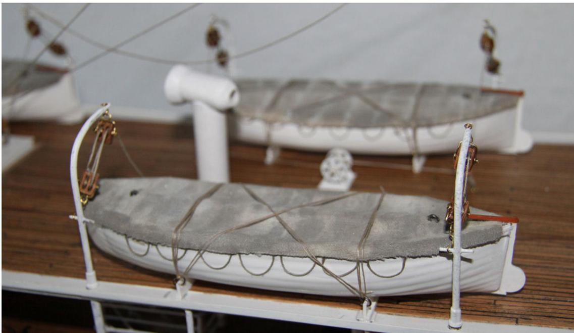
Die Davits lagern in 3mm MS-Rohr, welches auf dem Promenadendeck verklebt wird (und oben an dem 1mm Abschlussdraht verlötet werden kann). Dieses Rohr endet genau auf Höhe des Niveaus des Bootsdecks.
